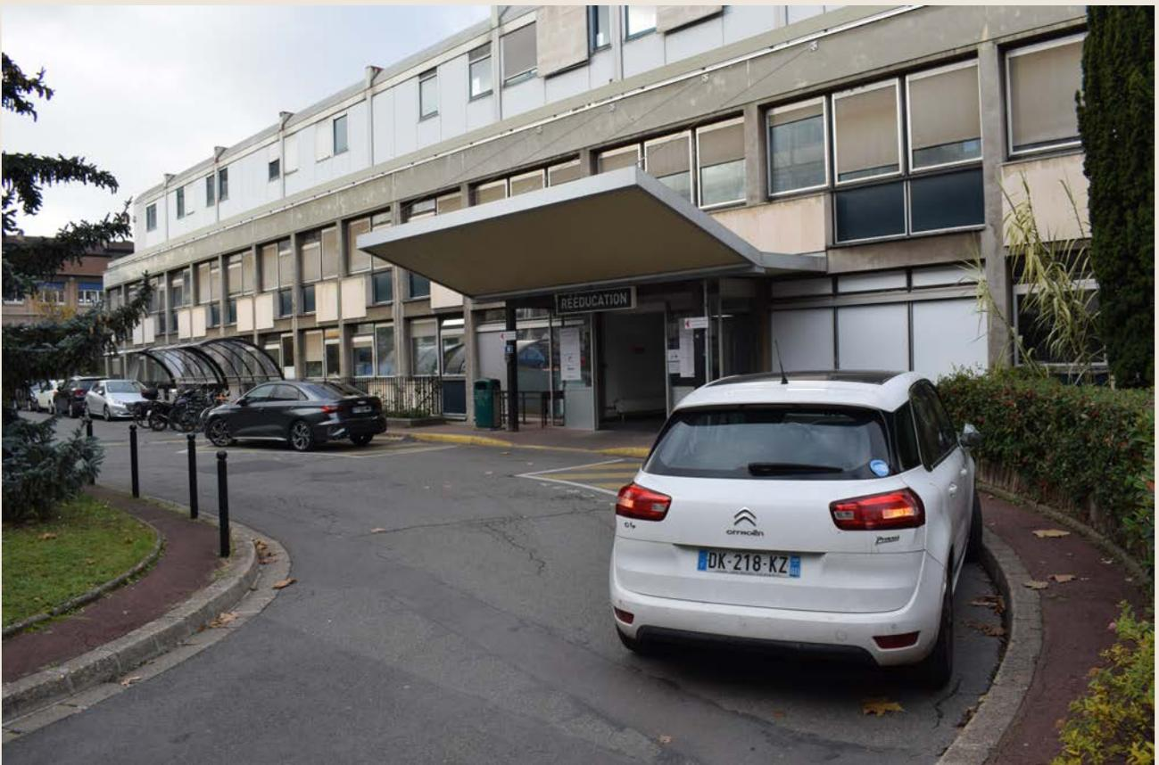
**Figure 21 - Entrée du bâtiment de rééducation où le trottoir n'est pas assez large pour permettre un fauteuil d'y passer, le dépôt minute est souvent occupé, 2022**
